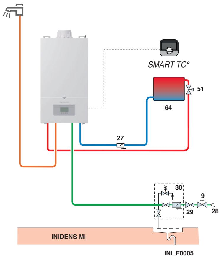
Un circuito diretto radiatori, con produzione istantanea di acqua calda sanitaria e sonda ambiente Smart TC°.
